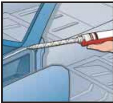
Terokal 5045 ist ein lösungsmittelfreier, zweikomponentiger Hochleistungs-Klebstoff auf Epoxidharzbasis mit vielen Einsatzmöglichkeiten bei der Verklebung von Karosserieblechen.
